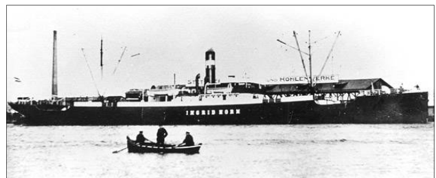
Ingrid Horn , ett tyskt ångfartyg, byggd 1901, längd= 89 m, bredd=12,6 m.
